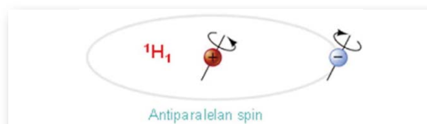
Slika 3. Protona vodonika ( ^1\text{H}_1 ) okružen je jednim elektronom. Oko elektrona se prostire magnetno polje koje potiče od sopstvenog spina i od njegovog orbitalnog kretanja. Magnetna polja elektrona moga se zanemariti.
