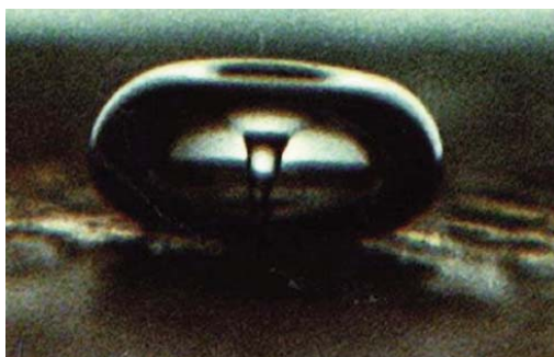
Slika 5. Mhurić vazduha nastao pri pojavi kavitacije. U sredini je vidljiv vrtlog koji nastaje u trenutku urušavanja mehurića. (Lawrence Crum Ph.D., University of Washington, Applied Physics Laboratory) 8
