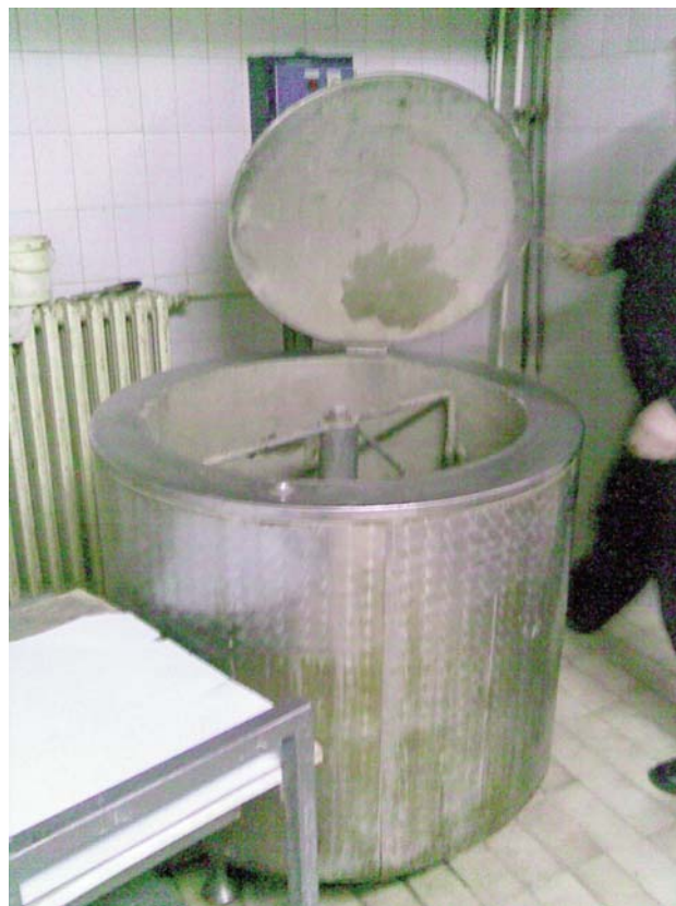
Slika 1. Specijalni kazan (mešalica) za zagrevanje i pripremu peloida
